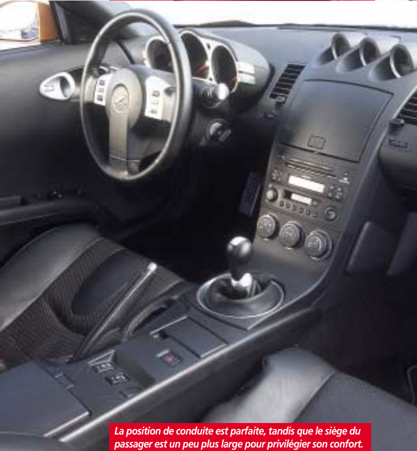
Le bloc à instruments est solidaire de la colonne de direction et bouge avec elle lorsqu'on l'ajuste en inclinaison.
