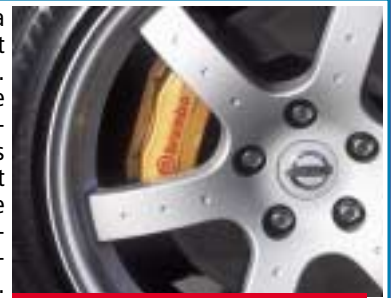
A l'avant, les gros disques ventilés sont pincés par des étriers fixes à 4 pistons.
